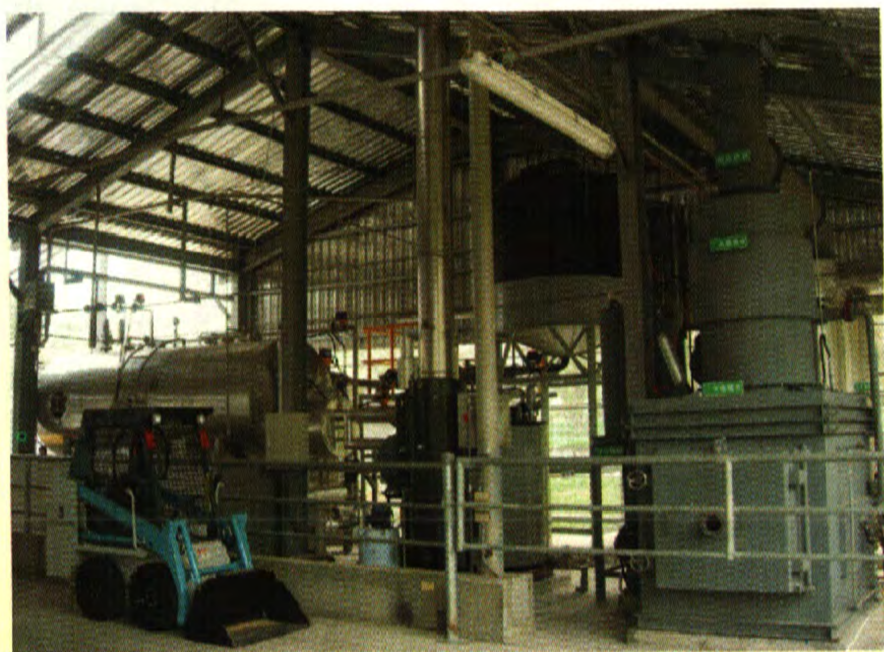
圖2. 畜產試驗所「基因轉殖畜禽研究型分子牧場」之焚化爐及高溫高壓滅菌鍋等廢棄物處理設施
