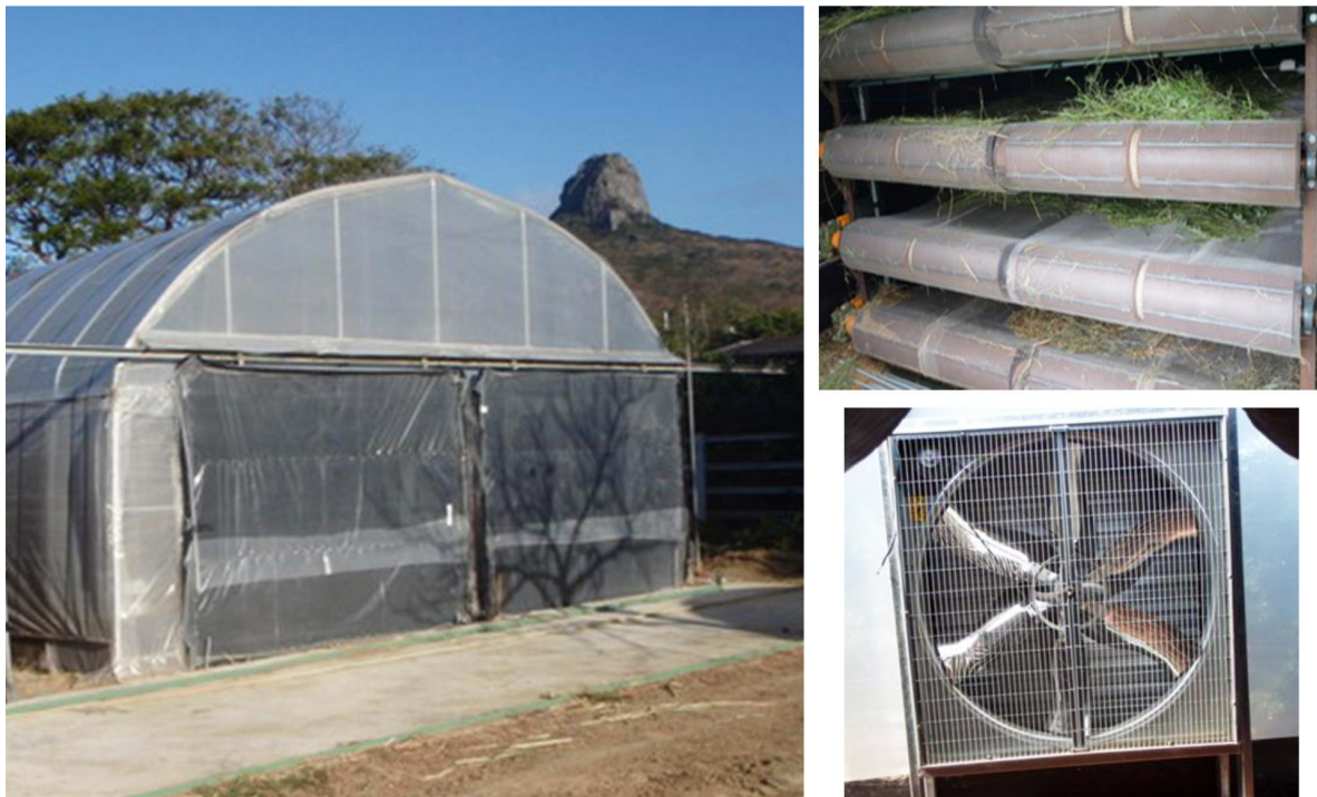
圖 2. 乾燥室外觀（左），右上為輸送系統（操作電力為 220 V 三相，各層輸送設備配置原動力 1/2 馬力之 50：1 減速機及設置限制開關控制相對位置），右下為風扇。
