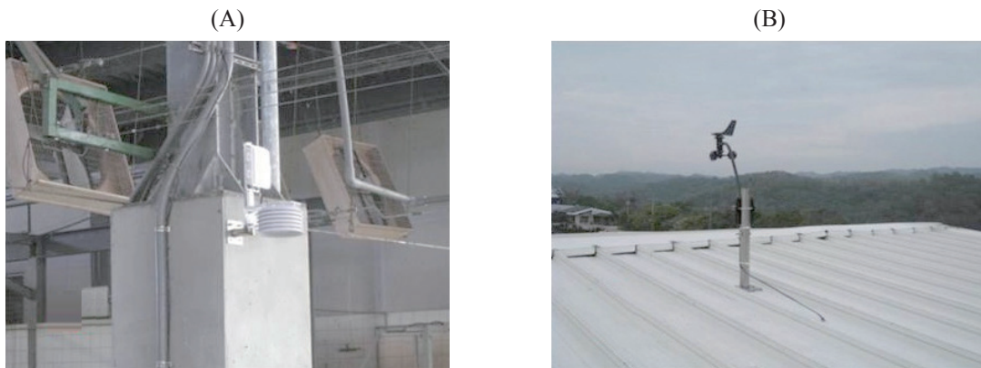
圖 1. 牛舍環境感測器之溫濕度感測器 (A)、風速風向感測器 (B)。
