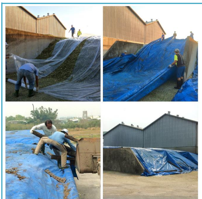
左上覆蓋膠膜、右上覆蓋帆布 左下壓放枕木及橡膠墊、右下覆蓋密封完成 / 張俊達 提供
