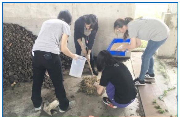
堆肥化之原料與調整材混合調整含水率 ／黃雅玲 攝影
