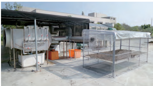
▲牛糞固形物利用太陽能乾燥房及洗滌設施去除脫水過程逸散之空氣污染物
