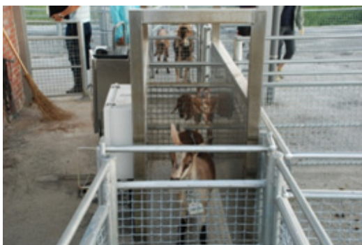
▲結合超高頻 RFID 與自動磅秤系統之 E 化作業欄
