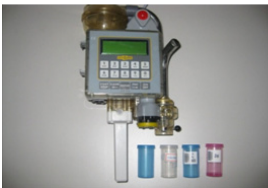
▲開發 LactoCorder® 乳計量器收集晶片乳樣瓶
