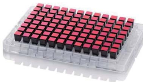
▲ 5K 高密度核苷酸變異微陣列晶片技術，以臺灣黃牛特有核 酸變異開發品種純度檢測服務
