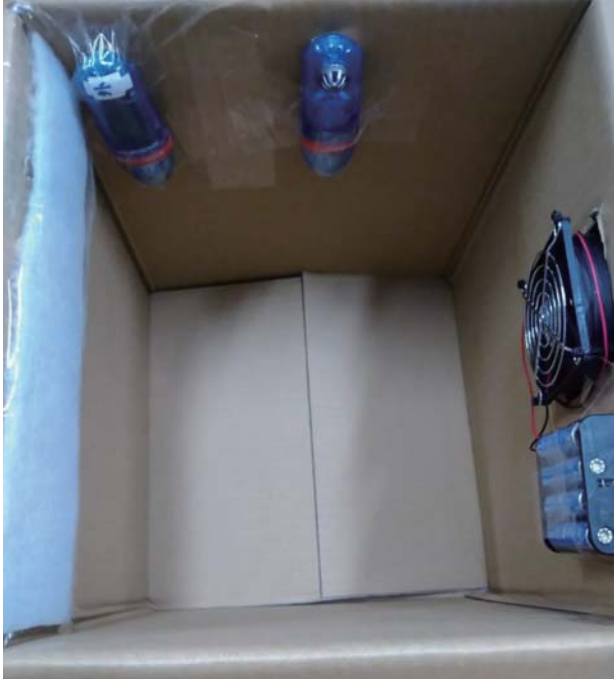
▲運輸箱內部配置圖，加裝拋棄式風扇、濾網及溫溼度紀錄器，以提升生物安全
