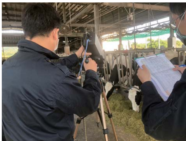
▲以熱影像儀量測記錄乳牛眼窩溫度
