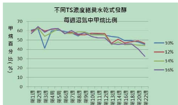
▲100 L 小型乾式發酵模組連續進料發酵，CH 4 含量變化
