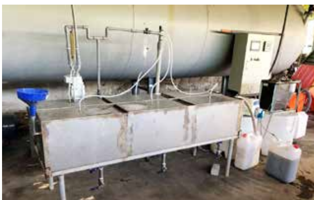
▲ 160 L 模槽試驗模擬豬場廢水溫室氣體排放測定。
