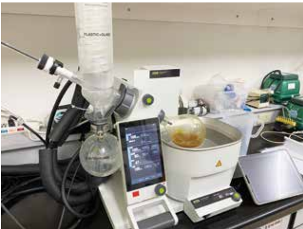
▲以減壓濃縮機進行養豬及養牛糞尿水之濃縮。
