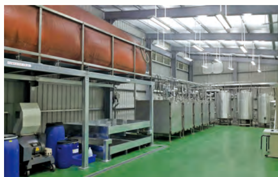
▲圖3. 工業技術研究院研發噸級乾式厭氧消化系統
