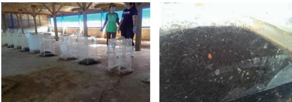
圖 1. 草炭對雞糞墊料揮發性氨氣吸收試驗設置情形。左邊為採氣罩設置完成的處理現場，右邊為草炭覆蓋於雞糞墊料上的近照。
